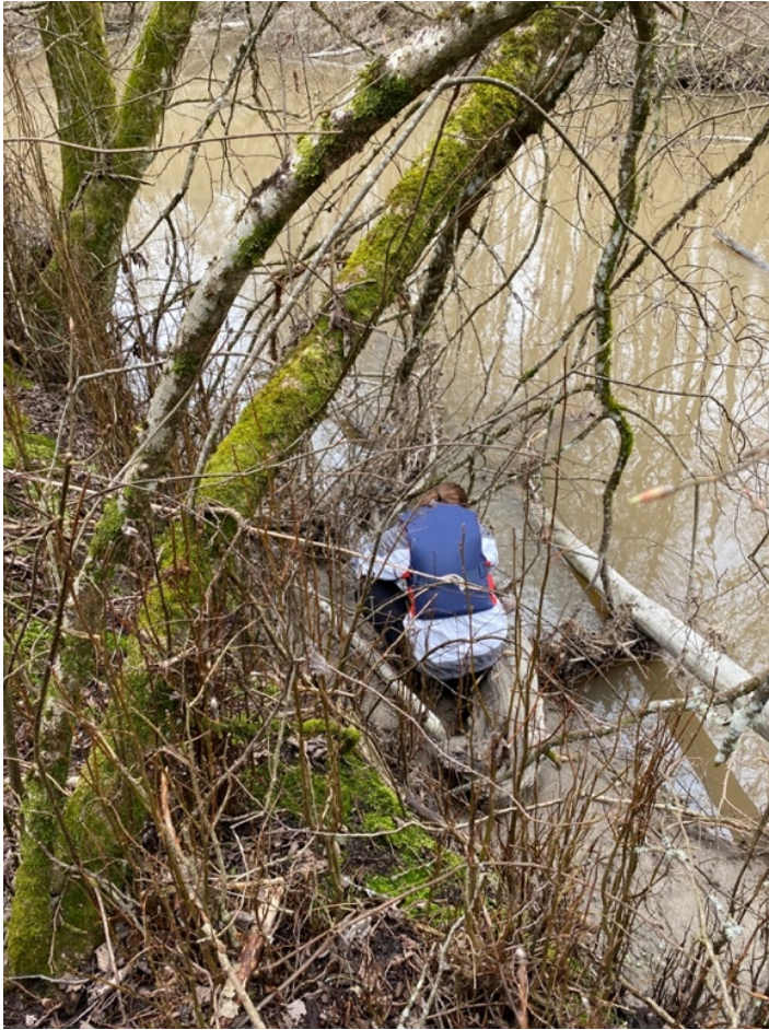
Figur 11: Bildet viser prøvetaker sikret med tau og redningsvest under prøvetaking i bratt område.
