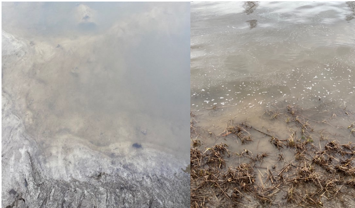
Figur 8: Bildet til venstre viser et eksempel på et ideelt prøvetakingspunkt med tydelig sedimentavsetning. Bildet til høyre viser et eksempel på et dårlig prøvetakingspunkt grunnet mye strå og høyvann.
