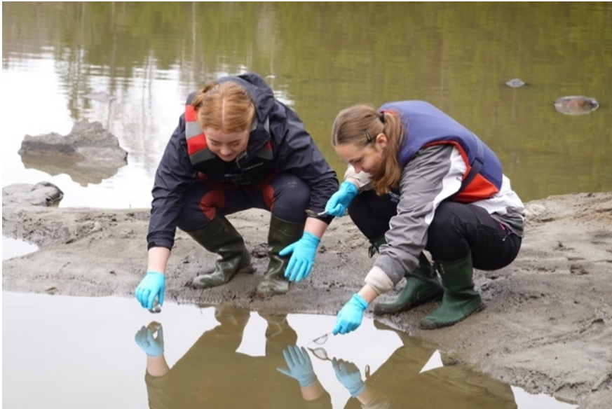
Figur 5: Innsamling av sedimentprøver, mandag 10. april 2023. På bildet skylles prøvetakingsutstyret før bruk.
