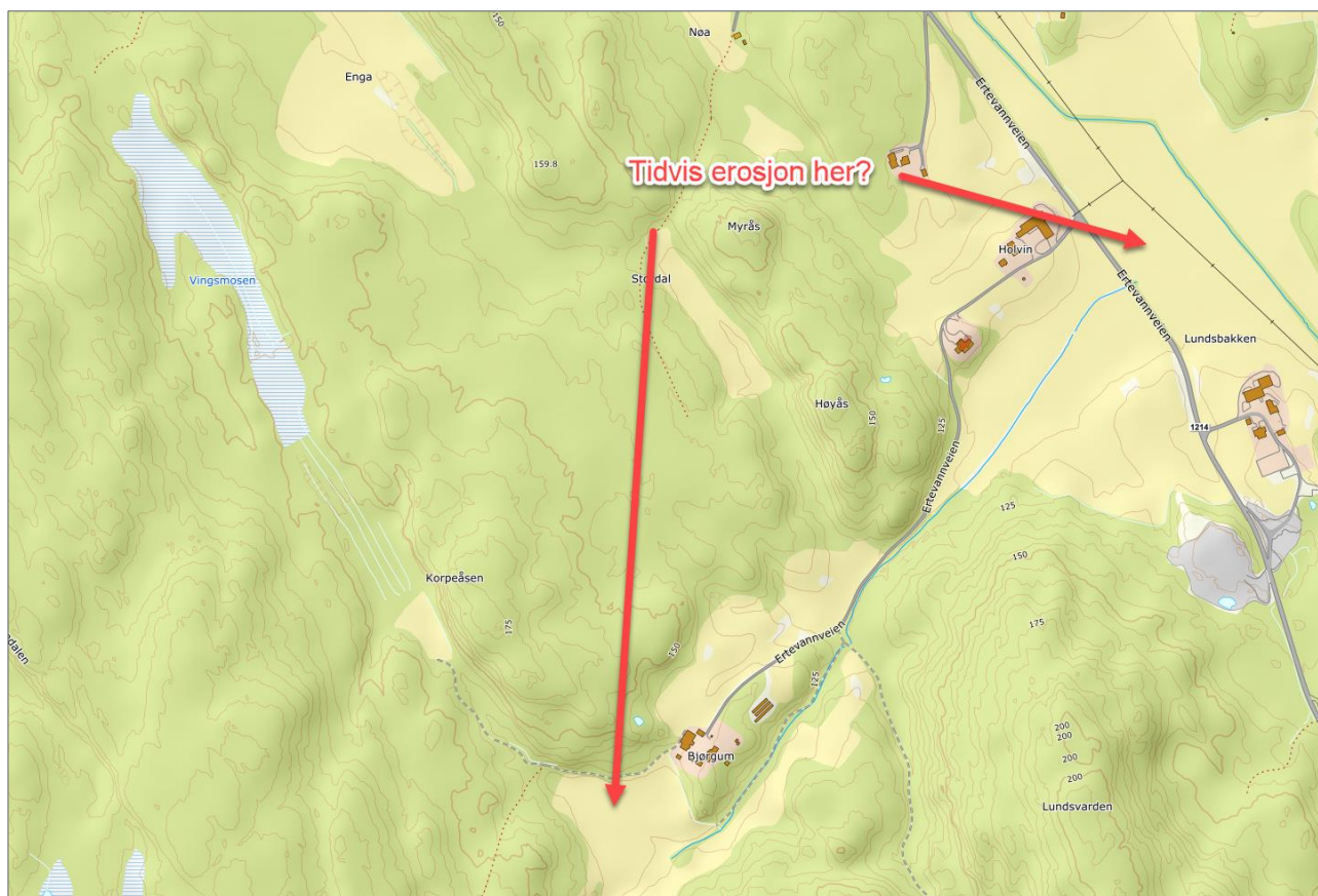
Figur 3-8. Eksempel. Vingsmosen og nedstrøms bekk ned til Øverbybekken. Dersom restaurering av myr gir større flomdempende effekt, kan utfordringer med overflateerosjon og bekkeerosjon bli mindre i nært bekkesystem nedstrøms.
